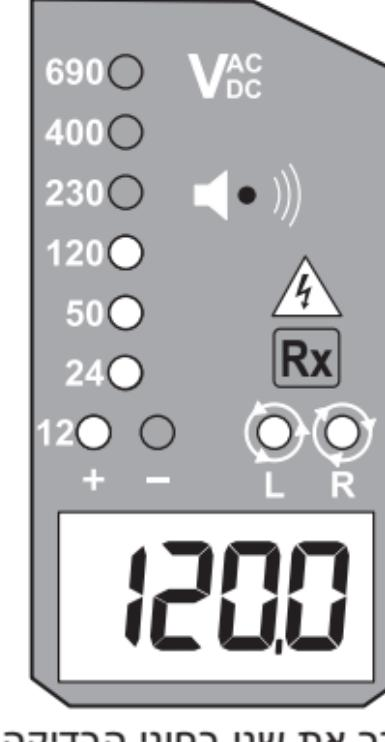
חבר את שני בוחני הבדיקה למעגל הנבדק. חיוי המתח יציג על ידי הדiodות פולטוט האור וצג הגביש הנוזלי. הזרם ישמיע אותך כאשר מתח הסוף הוא ערך מעל 38 VAC או ערך מעל 100 VDC.
