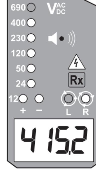
L-LED en R-LED's voor de faserotatietest kunnen werken op verschillende bedradingssystemen, maar een effectief testresultaat kan alleen worden verkregen op drie-fasen 4-kabelsystemen.
