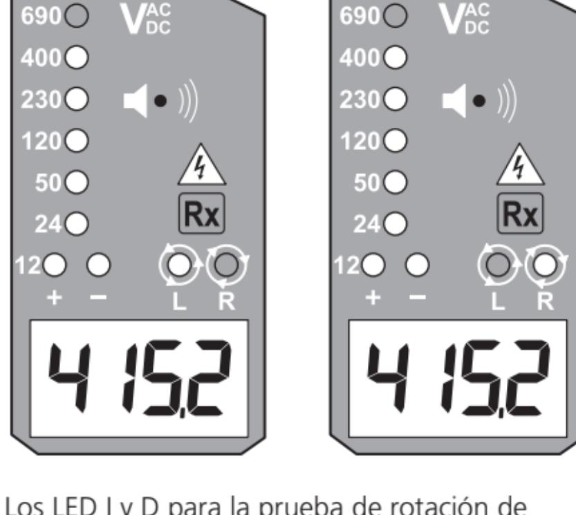
Los LED I y D para la prueba de rotación de fase pueden funcionar en distintos sistemas de cableado, pero solamente se puede obtener un resultado de prueba eficaz en sistemas de tres fases y 4 hilos.
